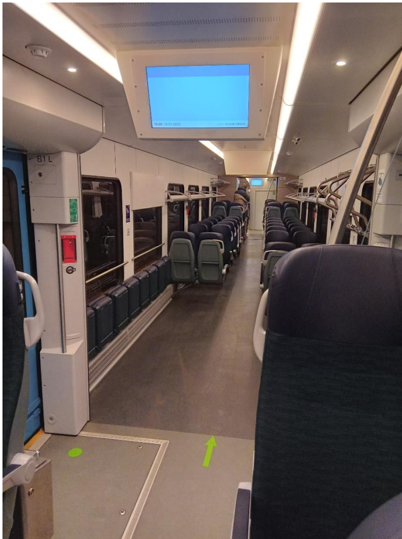
Slika 5: Sodobna notranjost, prilagojeni prostori za gibalno ovirane osebe, prostorno stranišče in elektronske informacijske table
