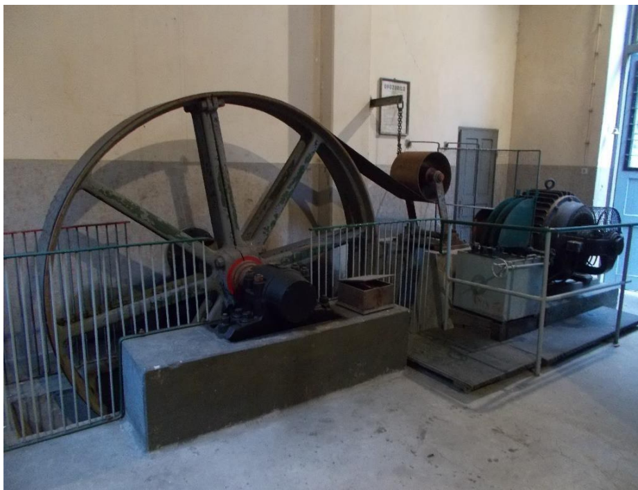
Elektromotor je preko jermena poganjal jekleno kolo in posledično veliko vetrnico v sosednjem prostoru (fotografija: lastno delo).
