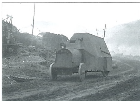
Slika 4: Junowiczev oklepni avtomobil. Dobro so vidne line za strojnice v škatlastem oklepem ohišju, spredaj oklepna zaščita za hladilnik motorja, prečna jeklena plošča, ki pokriva zadnje kolo in oklepljeno podvozje. Namesto strojnice Schwarzlose so nameščene strojnice Maxim .
