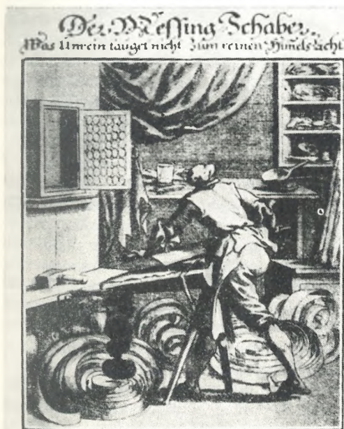
Upodobitev izdelovanja medeninastih kotličev, Iz: Peltzer: Geschichte der Messingindustrie
