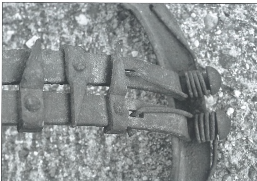
Detajl zobovja in vzmeti, ki sprožijo železne čeljusti.
