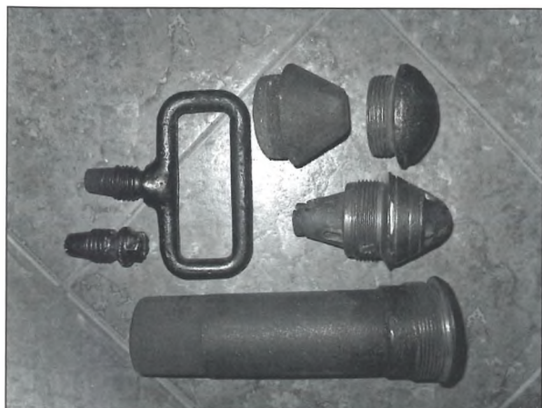
Adapter, dva transportna čepa, vžigalnik, tempirna glava in ročaj
