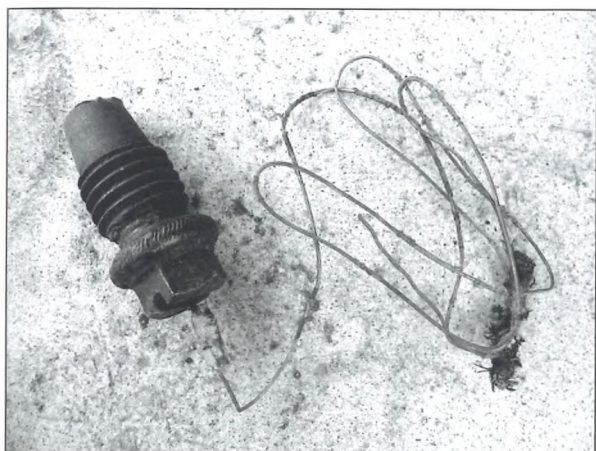
Vžigalnik za plinsko cev z napeljavo
